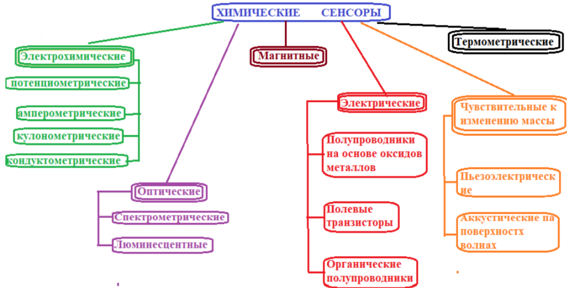
Рисунок 3 – Классификация химических сенсоров
