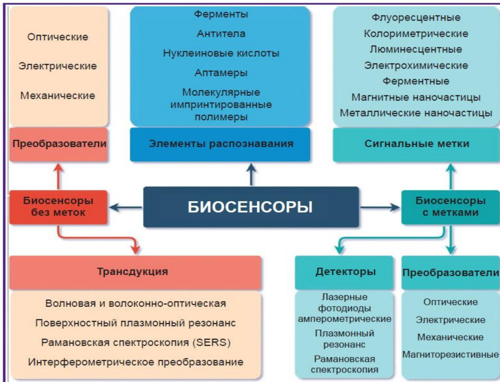
Рис. 3. Классификация биосенсоров на основании конструктивных стратегий методов обнаружения: использующих метки и без них (адаптировано по [33])
