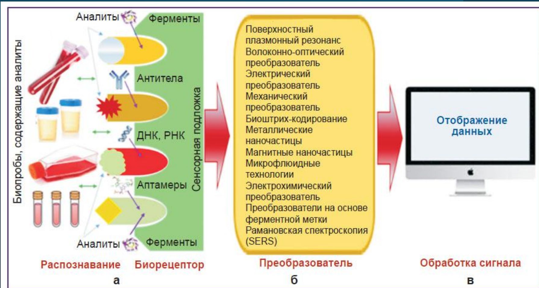
Рис. 2. Принципиальная схема строения биосенсоров
